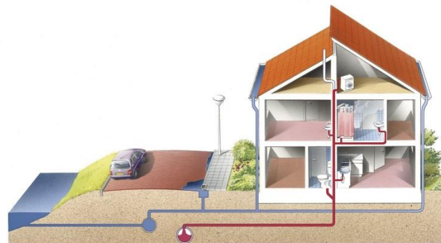
afbeelding 10: Gescheiden riolering. Bron: Paul Maas, Tilburg/Stichting RIONED
